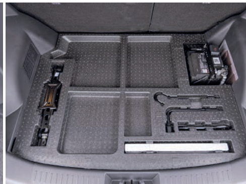
Kufr chery je podstatně větší a využitelnější, docela bizarní je ale „domeček“ pro baterku v podobě asymetricky vyboulené podlahy. Ta má pouze jednu polohu a pod ní pár oddělených odkládacích prostor.
