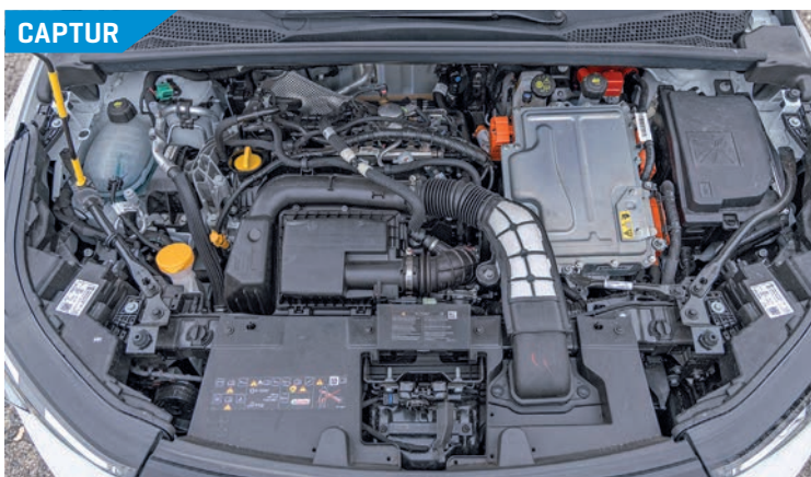
CAPTUR Atmosférická osmnáctistovka renaultu stačí na 80 kW a mnohem sebevědomějších 172 Nm. Multimódová hybridní skříň renaultu je geniálně efektivní, zároveň ale dosahuje nesrovnatelně lepší konzistence ve svých výkonech i s menší baterií.
