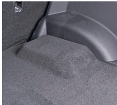
Kufr chery je podstatně větší a využitelnější, docela bizarní je ale „domeček“ pro baterku v podobě asymetricky vyboulené podlahy. Ta má pouze jednu polohu a pod ní pár oddělených odkládacích prostor.
