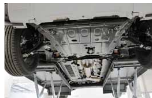
Vzhledem k ceně auto rozhodně není ošizené. Pod motorem je poctivý ocelový kryt s protihlukovou izolací zevnitř. Spodek dusteru je dokonce z výroby nastříkán asfaltovým protikorozním nátěrem - zrovna ten kryt velmi důkladně.
