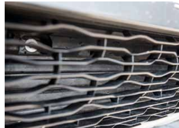
V tomto roce proběhla aerodynamická vylepšení vozu. Objevily se aktivní klapky před chladičem a zástěrky rozrážející vzduch před předními koly.
