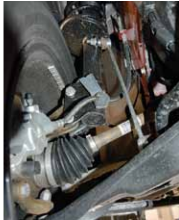
Duster nikdy neměl stabilizátor chycený do ramen přes malé silentbloky jako menší osobní modely. Řešení s dlouhými táhly může být sice choulostivější, ale zajišťuje daleko přesnější odezvu na jemné pokyny řízení.
