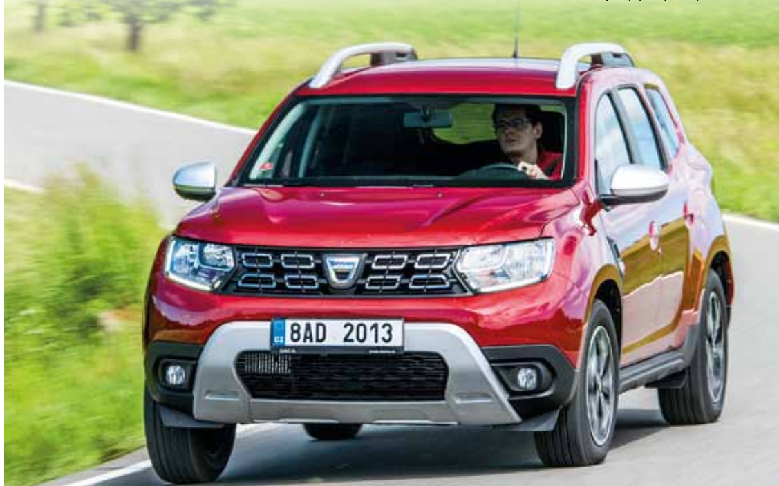
Na této fotce je krásně vidět, že duster je vlastně vyvážené a ovladatelné auto. Zadní pneumatika se deformuje stejnou měrou jako přední, což znamená neutrální chování.
