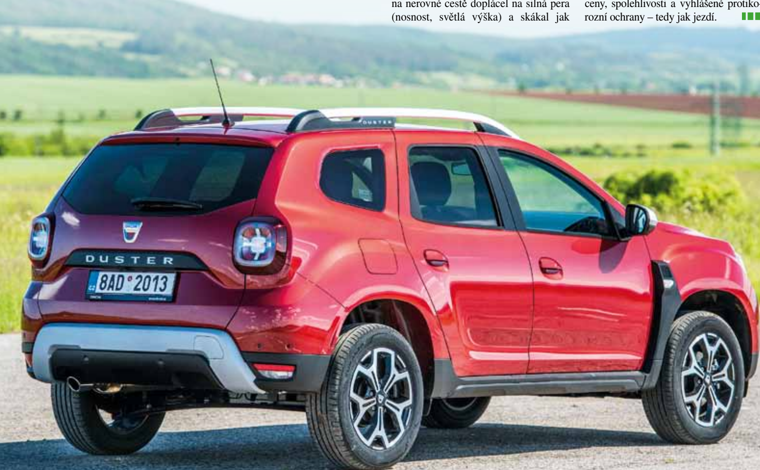
Z tohoto pohledu nejlépe vynikne extrémní světlá výška 210mm a zadní nájezdový úhel 34°
