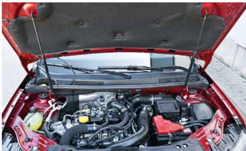
Skromný tříválec pod velkou kapotou. U levného vozu překvapuje důsledná protihluková izolace i dvojitě plynových vzpěr.
