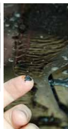
Vzhledem k ceně auto rozhodně není ošizené. Pod motorem je poctivý ocelový kryt s protihlukovou izolací zevnitř. Spodek dusteru je dokonce z výroby nastříkán asfaltovým protikorozním nátěrem - zrovna ten kryt velmi důkladně.
